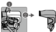
Зніміть захист стабілізатора з камери
